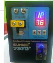
SOLDADORA DE PUNTOS #2 CON SETUP DE 55 DE POTENCIA
