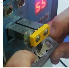
13.- Girar la fixtura y colocar una tira de níquel de 8mm en la terminal (-) **NO CENTRADA sino RECARGADA AL LADO IZQUIERDO Y HACIA ARRIBA.**
