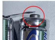
Puntos de soldadura muy marcados en terminales (-) (tira de níquel abollada)
