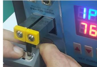
4.- Colocar una tira de 8mm en la terminal (+) de la batería de la esquina izquierda.
