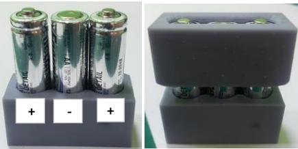
2.- Colocar una tira de níquel de 20mm en las dos pilas de la derecha.
