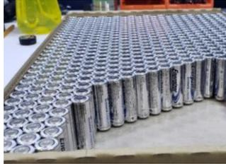
NOTA: Evitar que las baterías caigan. En caso de detectar una batería sobrecalentada o abollada, informar al supervisor de inmediato.
