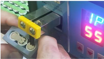
15.- Sacar baterías de la fixtura y hacer prueba de giro a todas las piezas. Anotar unicamente la cantidad de piezas que se desoldan, en el reporte de producción IMTECH-FPROD-001.
