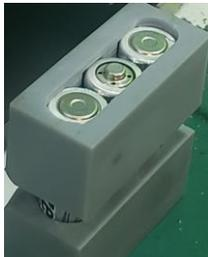
7.- Colocar una tira de níquel de 20mm en las 2 baterías que se muestra a continuación.
