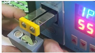
11.- Girar la fixtura y dar 2 pulsos en la terminal (-) de la batería de enmedio.
